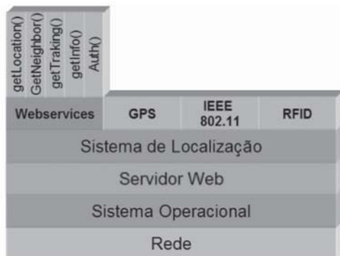
Figura 11: Arquitetura do Sistema de Localização.
