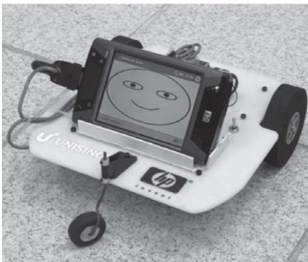
Figura 2: Projeto de Aprendizagem – Robô controlado por Bluetooth
